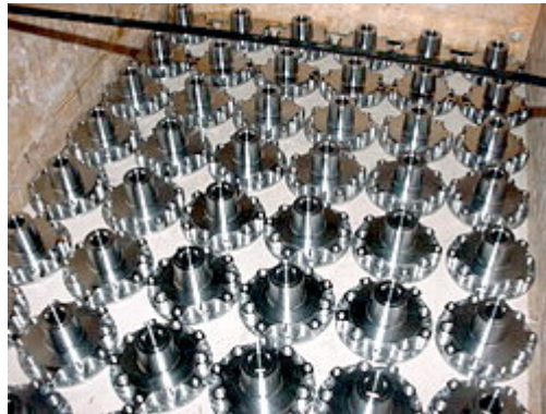
Bildschöne Detail-Lösungen, sauber gefertigt Radnaben warten auf den letzten Schliff
